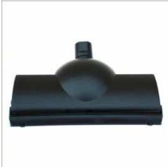
El aire mueve un rotor que transmite, a través de una correa dentada, la posibilidad de giro de un cilindro delantero que permitirá peinar la alfombra o moqueta sobre la que se trabaja. Tiene una abertura que es una fuga falsa para regular la potencia según la fuerza necesitada.
